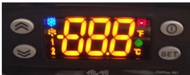
Fig. 4. Elementy sygnalizacyjne i kontrolne sterownika Eliwell .
