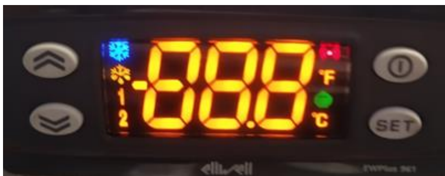
Ryc . 3.3.1. Wskazanie oraz kontrola elementy z the kontroler Eliwell .
