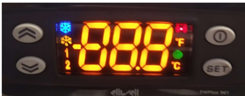
Рис. 3.3.1. Індикація та елементи управління контролера Eliwell.
