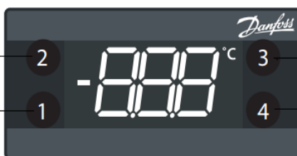
Рис.5 – Электронный контроллер DANFOSS ERC 112C
