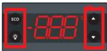
Рис. 3.1.2: Елементи управління контролера Danfoss ERC112C.
