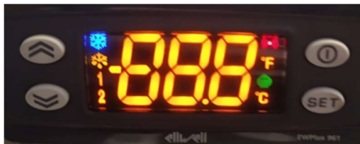
Рис. 4. Індикація та елементи управління контролера Eliwell.
