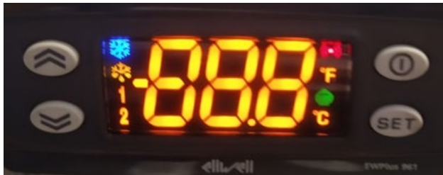
Рис. 4. Індикація та елементи управління контролера Eliwell.
